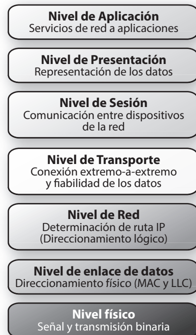
Figura 8.1 Pila de capas de un sistema de información según la OSI.
