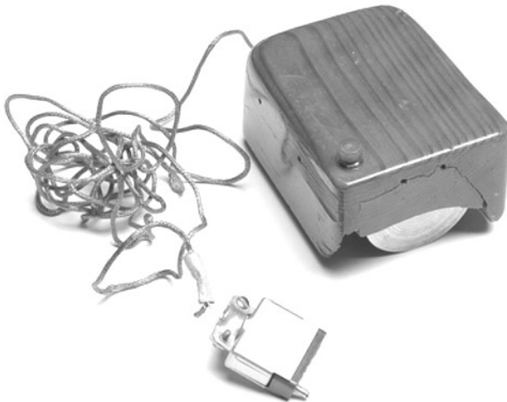
Figura 5.1 Mouse original de Douglas Engelbart, creado en la década de 1970.
