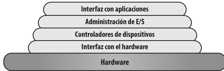
Figura 5.3 Capas del software de central de dispositivos de E/S.
